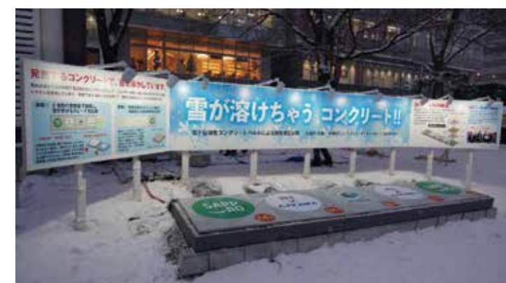
「さっぽろ雪まつり 大通会場」で行われた発熱コンクリートの実証実験 (札幌市共催)
