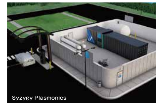
アンモニアを水素に転換する水素ステーション
