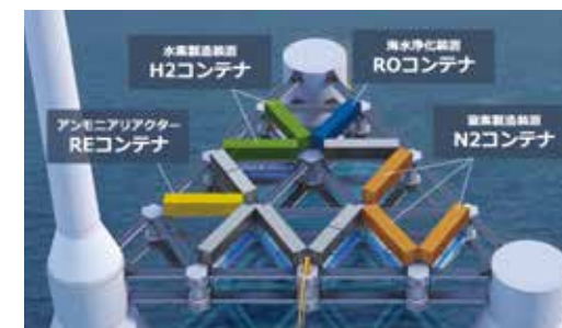
米スターファイヤーエナジー社のグリーンアンモニア製造モジュール
