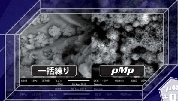
走査型電子顕微鏡 (SEM) による微細構造観察や、エネルギー分散型X線による元素成分分析により、pMpは時間の経過とともに一括練りより圧倒的に豊かな水和物を生成することが確認されました。材齢28日では劣っているように見えた強度も早々に挽回、その後も数十年単位で水和が進行し続けるのです。
