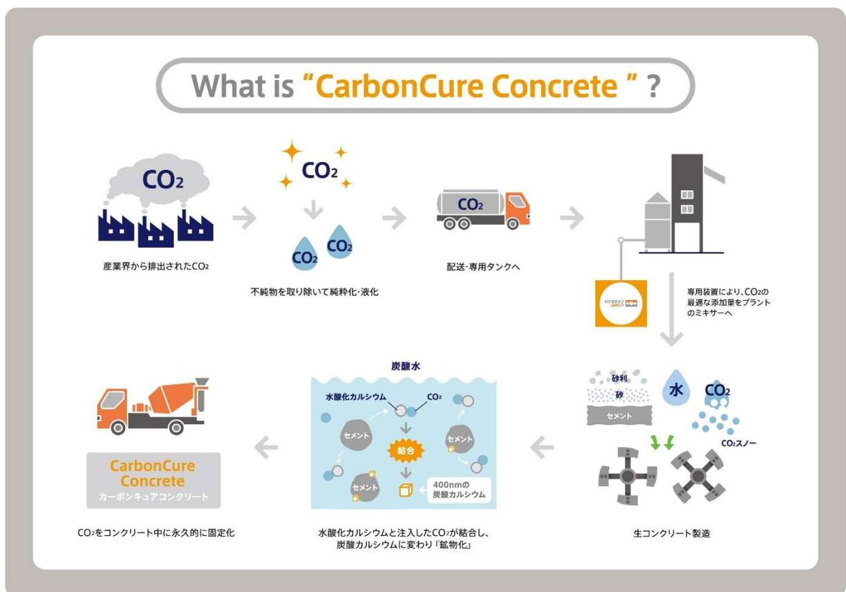
通常のコンクリートより圧縮強度が大幅に増すため、セメント使用量を戦略的に減らし、セメント使用量の適切な削減による配合修正で生産コストを低減させながら、低炭素型の、環境にやさしいコンクリートを供給することが可能となるわけです。
