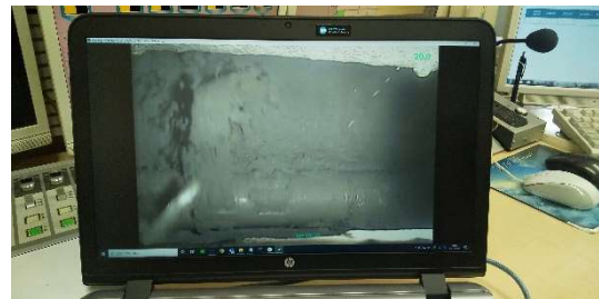
写真2. AIスランプ判定状況(ミキサ画像)
