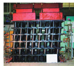
各種試験を実施 (写真は交番載荷試験)
