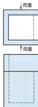
壁面にまったく壁がない場合は構造上破損するおそれがある
