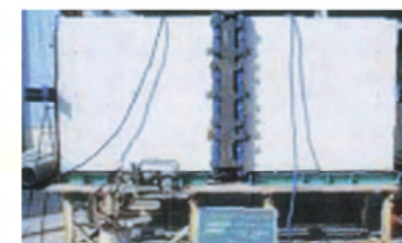
水平変位 抜け出し 35mm 実施状況(抜け出し35mm)
